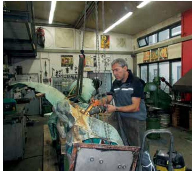
mit Owatrol konserviert. In die Kontaktstellen von Kupfer und Stahl wurde Teerfilz eingebracht, um beide Metalle zu trennen und so weiterer Korrosion vorzubeugen.
