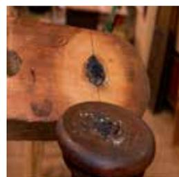
*Ein Zapfen zur Plattenbefestigung ist gebrochen, die Verleimung mit Polyvinylacetat ist gelöst.*
