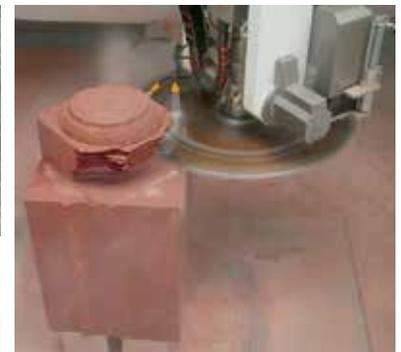
Nachdem mit Bohrwiderstandsprüfungen die Standfestigkeit der Originalsäulen festgestellt werden konnte, sollte das verwitterte Material gleichmäßig abgetragen werden. Um negative Auswirkungen auf die Proportionen zu vermeiden, brachte der Steinmetzbetrieb die Idee auf, die Säulen von runden auf elliptische Querschnitte umzuarbeiten.
